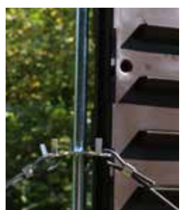
... die drei Schlitzfallen bei den Aufhängehaken einhängen. Tipp: Für leichteres Einfädeln die Aufhängehaken mit einer Zange etwas nach außen biegen.
