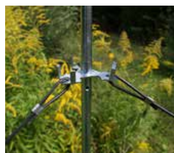
... die drei Schlitzfallen bei den Aufhängehaken einhängen. Tipp: Für leichteres Einfädeln die Aufhängehaken mit einer Zange etwas nach außen biegen.
