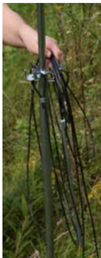
... den Dreifallensteher darauf platzieren. Danach die 3 Abspannseile gut spannen und mit den mitgelieferten Heringen im Boden verankern...
