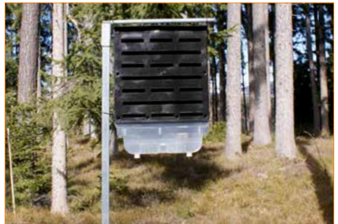
MultiWit® Borkenkäferschlitzfalle ist für den Massenfang von vielen Borkenkäferarten (z.B. Buchdrucker, Kupferstecher u.v.a.) geeignet – Trocken- und Nassfangmethode möglich.
