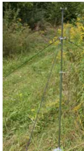
... den Dreifallensteher darauf platzieren. Danach die 3 Abspannseile gut spannen und mit den mitgelieferten Heringen im Boden verankern...
